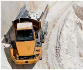
يتم حمل كتل أصغر من الرخام بعيداً عن الحجر بواسطة شاحنات كاترلر المفصلية من فئة 725.
