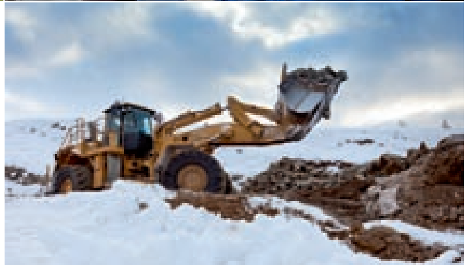
تلعب شيبولات كاترلر 988H (أعلاه). ومهدات الطرق 16H دوراً أساسياً في إنشاء وصيانة طرق تمتد إلى مسافة 150 كم.
