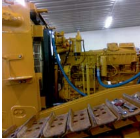
حزمة إعادة البناء الجديدة 3406 من كاتربلر تستخدم لترميم محرك في بولندا.
